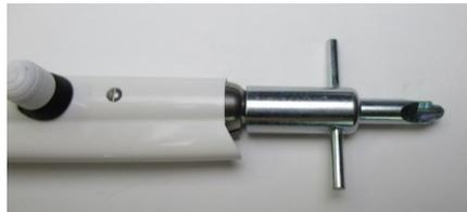
Das Handstück innen und die Spitze nun mit einem trockenen Pinsel reinigen. Zum Öffnen der Spannzange den Spannkopf nach vorne schieben.
