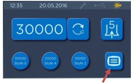
Anschließend klicken Sie auf <Filterwechsel>. Bestätigen Sie den Filterwechsel mit <JA>.
