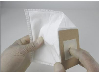
Öffnen Sie den Staubkammerdeckel und entnehmen Sie den alten Filter.
