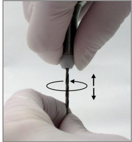
Üben Sie nur leichten Druck beim Einführen aus. Der fest sitzende Staub wird sich dabei lösen und durch das Drehen des Bohrers nach außen transportiert. Halten Sie das Handstück während des Vorgangs nach unten gerichtet, damit Staub besser aus dem Handstück fallen kann.
