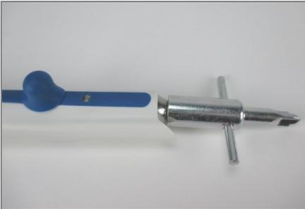
Das Handstück innen und die Spitze nun mit einem trockenen Pinsel reinigen. Zum Öffnen der Spannzange den Spannkopf nach vorne schieben.
