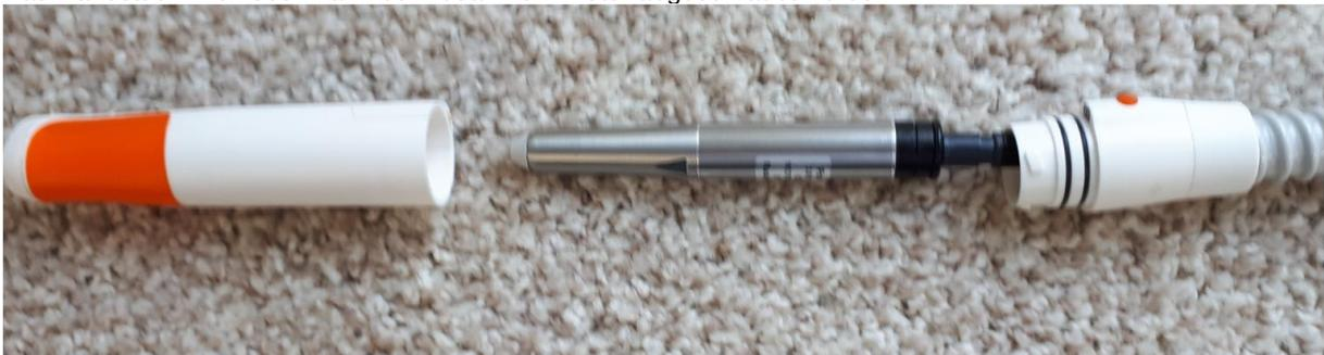
Beim Zusammenbau das Handstückinnenleben mit Motor in die vordere Handstückhülse einführen
