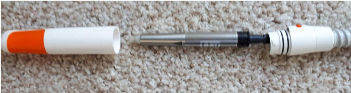
Drücken Sie das Handstückinnenleben mit Motor aus der vorderen Handstückhülse
