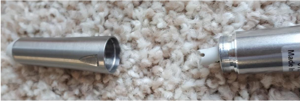
Das Handstückinnenleben kann bei Bedarf vom Motor abgeschraubt werden
